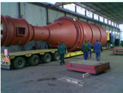
Gewicht: 4 x 13.000 kg Maße: 1.850 x 427 x 427 cm Fahrzeugtyp: Kesselbrücke
