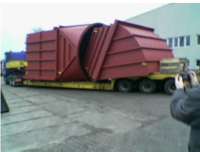
Gewicht: 4 x 13.000 kg Maße: 1.850 x 427 x 427 cm Fahrzeugtyp: Kesselbrücke
